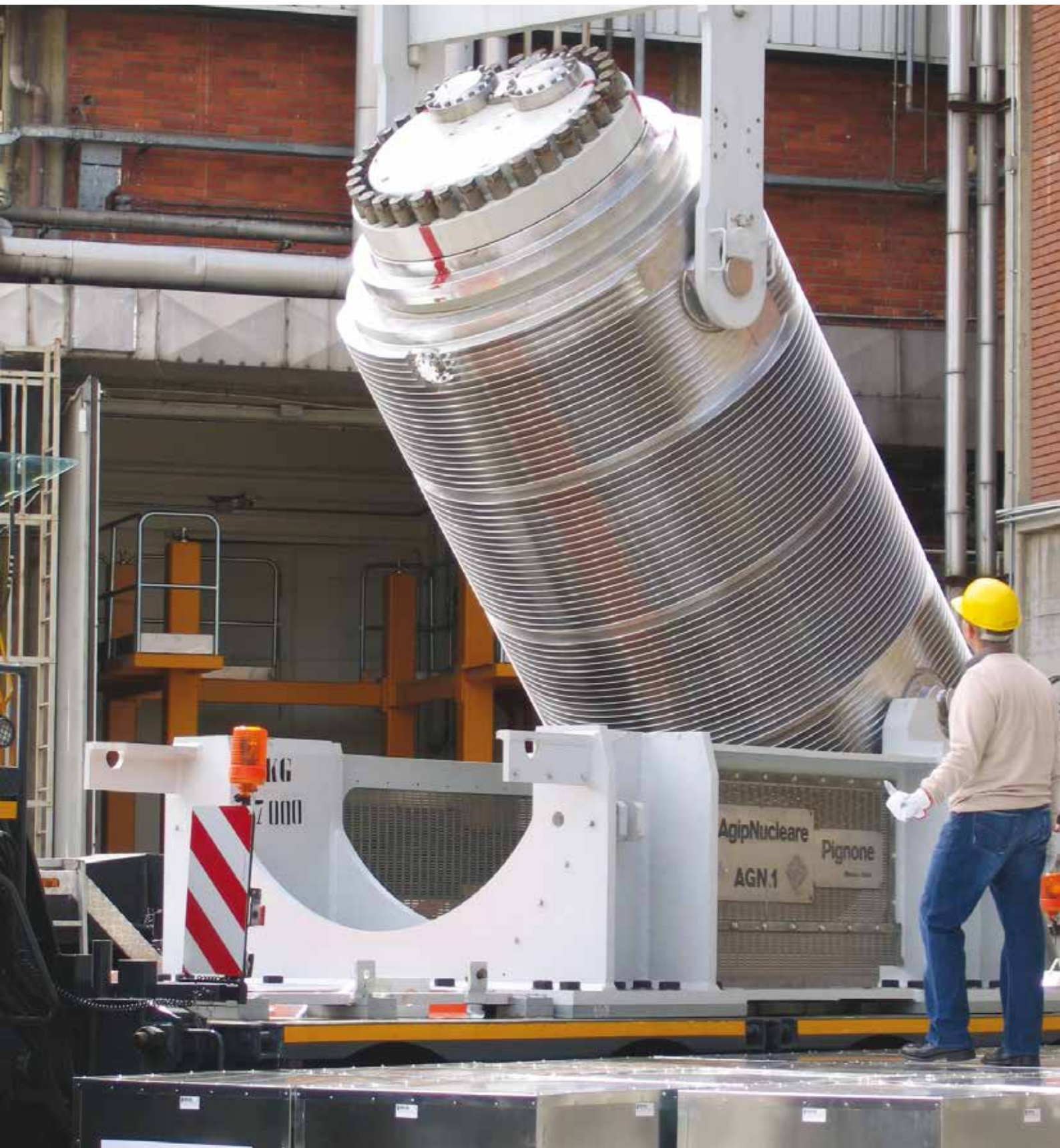
Foto 5.16 Operazioni di carico delle scorie Fonte ISPRA
